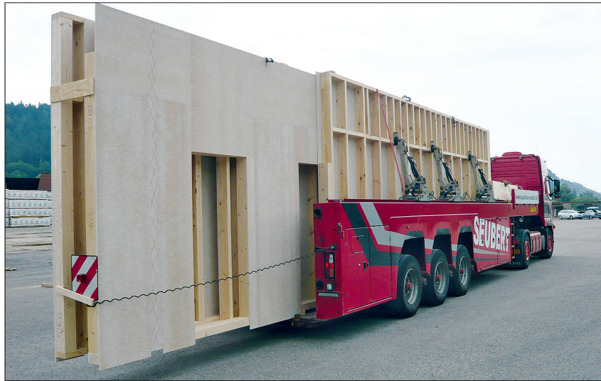
Junginger liefert Wandelemente bis zu einer Höhe von 3,70 m. Genutzt werden dazu Innenlader, für die keine Sondergenehmigung nötig ist. Fotos: Junginger
